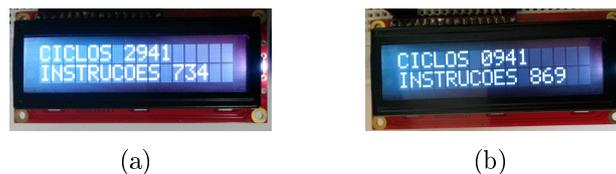
Figura 4.15: Em (a) o número de ciclos e instruções do multiciclo e em (b) *pipeline* do processamento do algoritmo *sort*.
