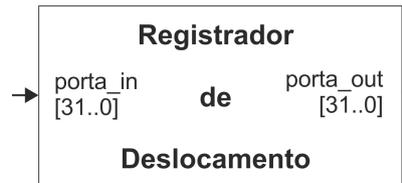
Figura 3.7: Bloco funcional do registrador de deslocamento.
