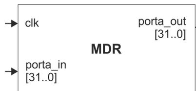
Figura 3.4: Bloco funcional de um registrador.
