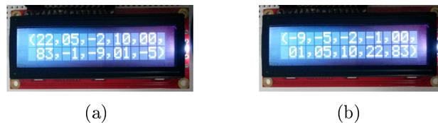
Figura 4.14: Em (a) o vetor com os elementos antes do processamento e em (b) o vetor com os elementos ordenados pelo algoritmo *sort*.
